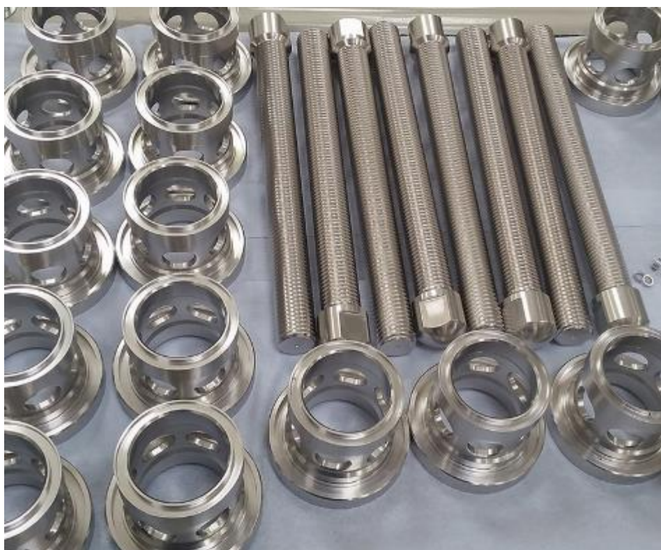
MAN Diesel & Turbo emner efter Expanite overfladehærdning
